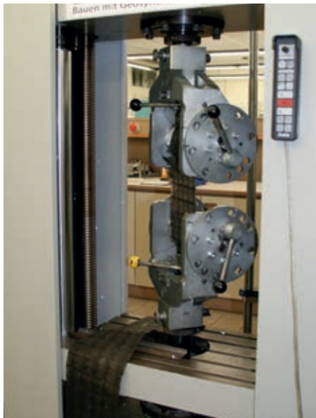
Zugversuch am breiten Streifen nach EN ISO 10319.
